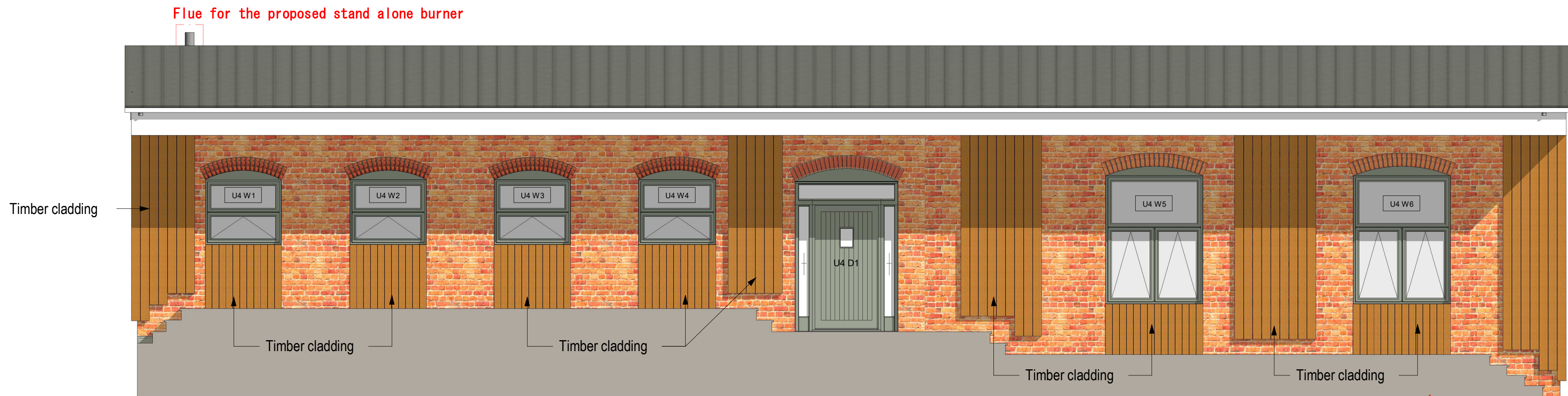
2 Unit 4 NE Elevation 1 : 50
